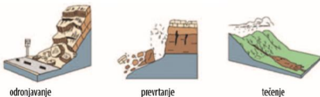
Slika 11: Prikaz osnovnih tipova klizanja prema mehanizmu kretanja
